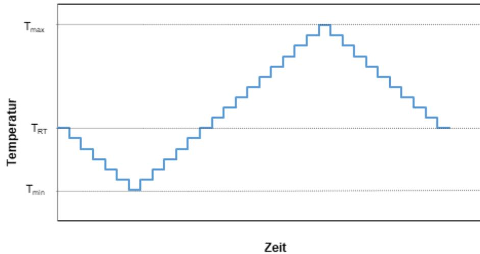
Bild: Temperaturprofil – Stufentemperaturtest
